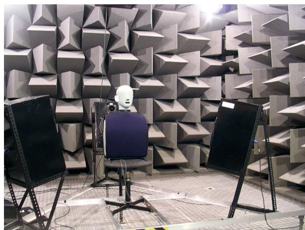
Fig. 8.3 registrazione binaurale con una "dummy head" (testa finta), in una camera anecoica.
